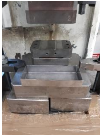
Slika 54 Predodžba alata za ravnjanje platine povlakača
