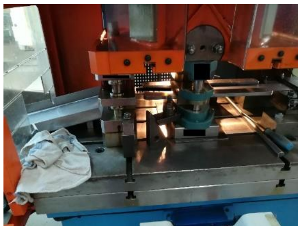
Slika 53 Predodžba automatizirane izrade platine povlakača na starom alatu
