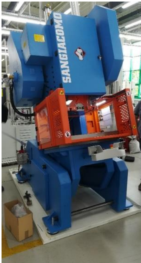
Slika 57 Predodžba nagibne preše
