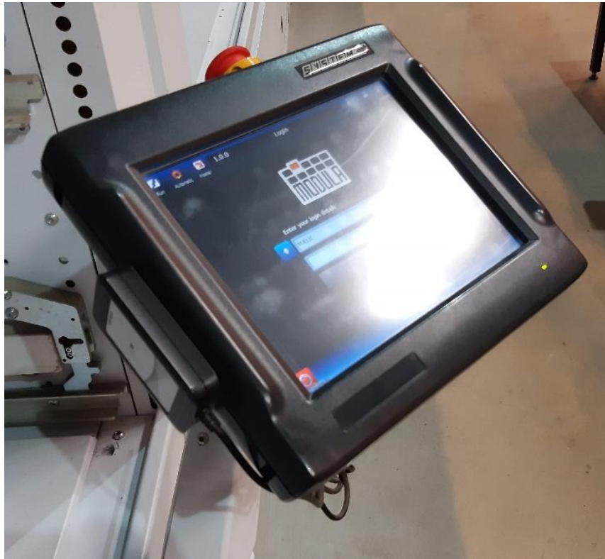
Slika 16. RFID čitač pričvršćen na stranu industrijskog panela
