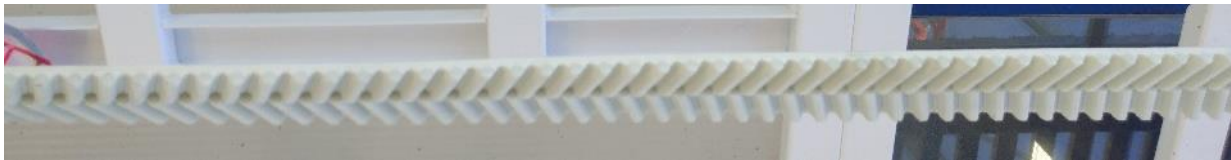
Slika 7. Samo-centrirajući zupčasti remen
