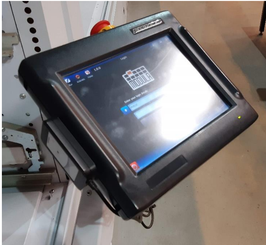
Slika 16. RFID čitač pričvršćen na stranu industrijskog panela
