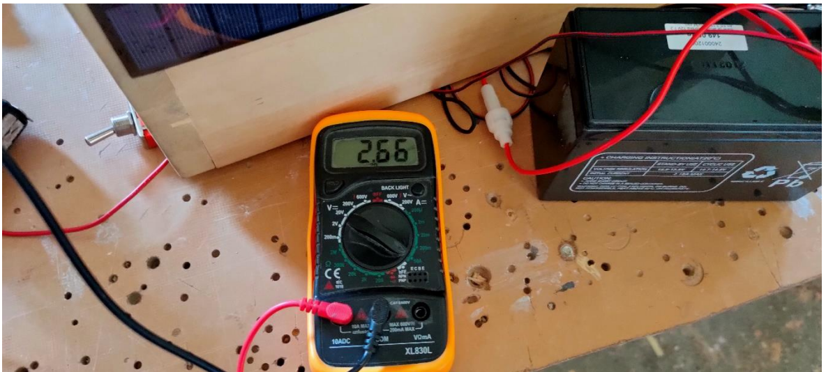
Slika 21. Struja na TEC-u [11]
