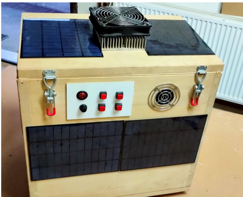
Slika 9. Prednja strana prijenosnog hladnjaka [11]
