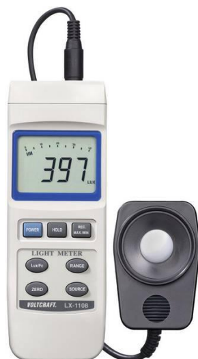
Slika 8. VOLTcraft LX-1108 Digital luxmetar
