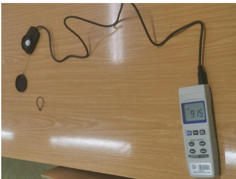
Slika 6. Mjerenje osvijetljenosti predavaonice lux-metrom
