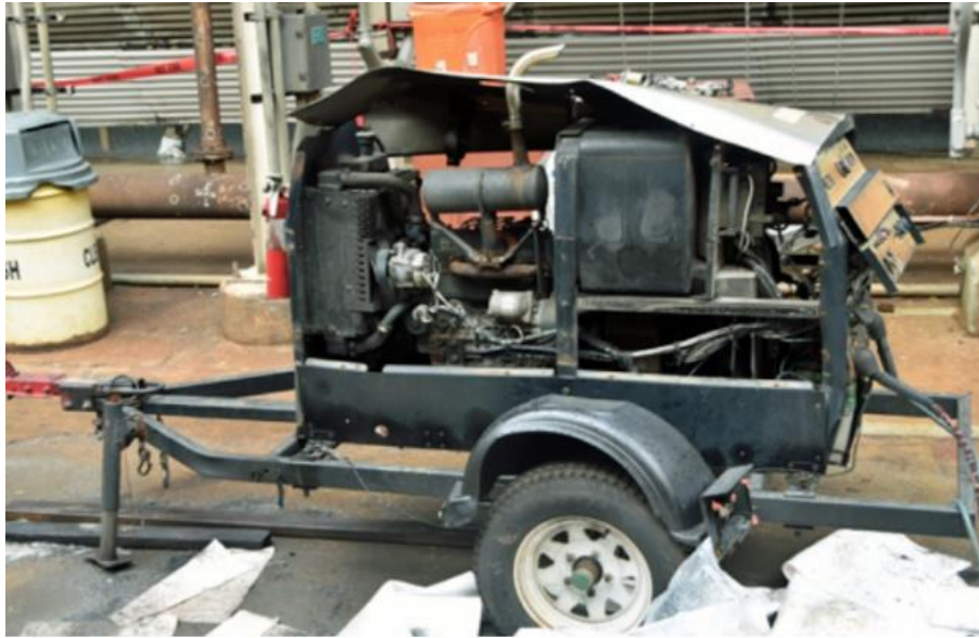
Slika 9. Uređaj za zavarivanje koji je uzrokovao požar [23]
