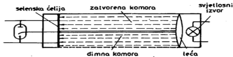
Sl. 19. Način rada optičkog javljača požara s apsorpcijom svjetlosti [6]
