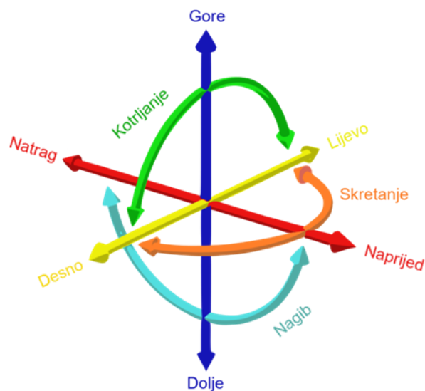
Slika 1. Prikaz 6 stupnjeva slobode [6]
