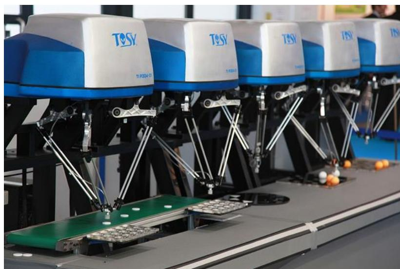
Slika 7. Roboti s paralelnom vezom [9]
