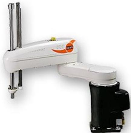
Slika 10. Montažna robotska ruka selektivne usklađenosti [12]
