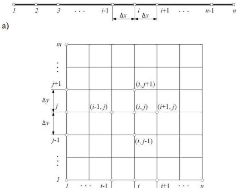
Slika 18 Raspored čvorova: a) jednodimenzijski, b) dvodimenzijski
