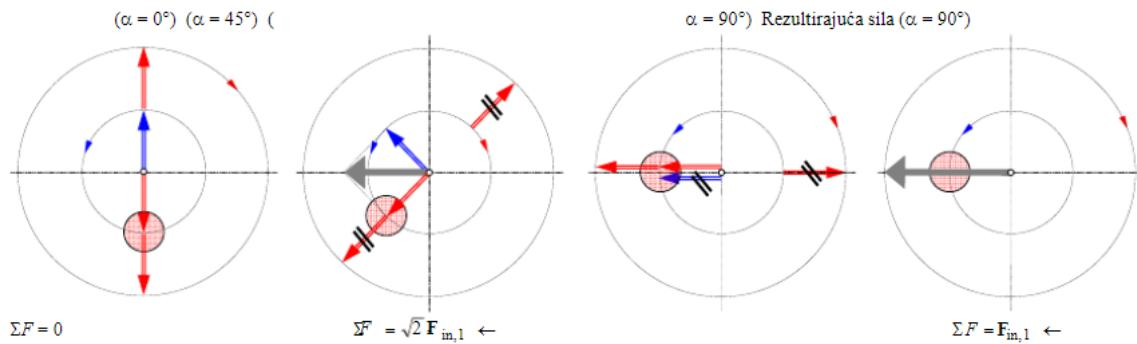
Slika 14 Prikaz protuutega na koljenastom vratilu
