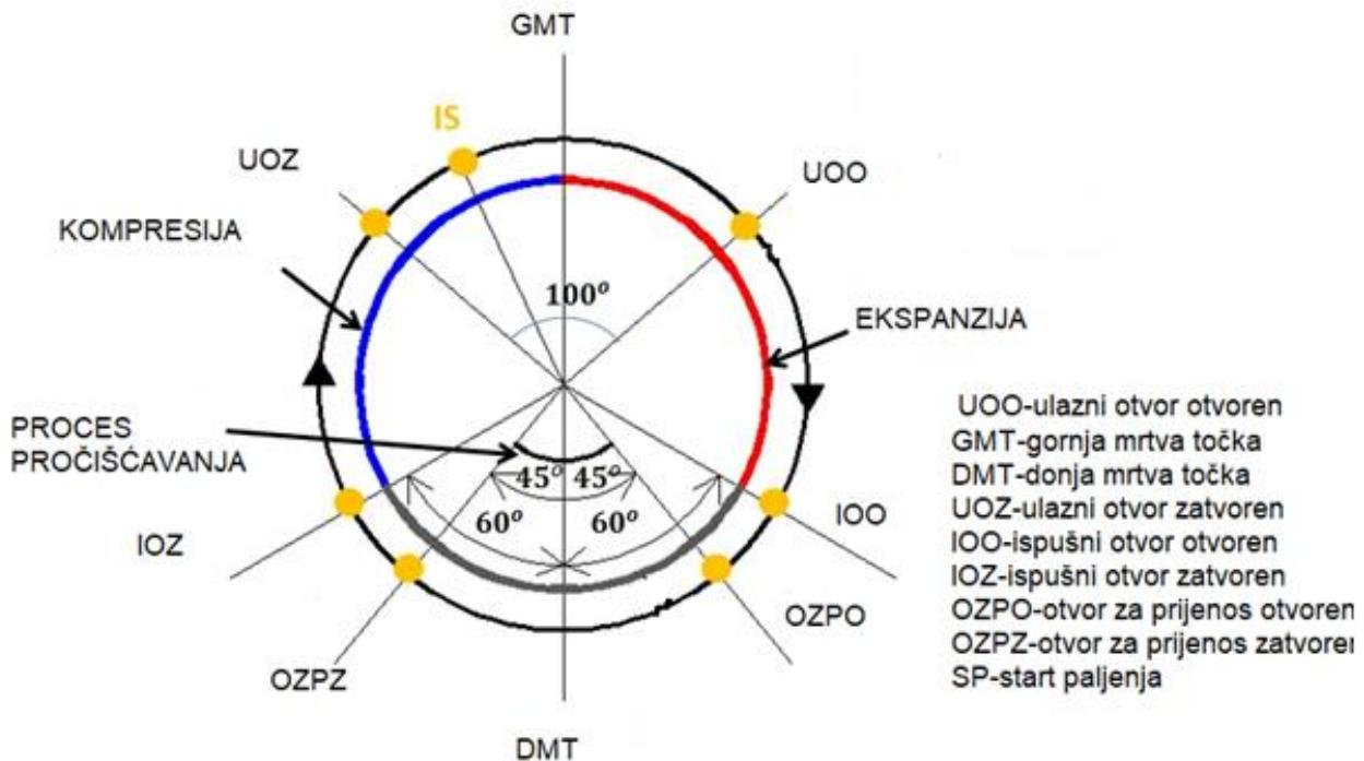
Slika 9 Vremenski dijagram benzinskog motora
