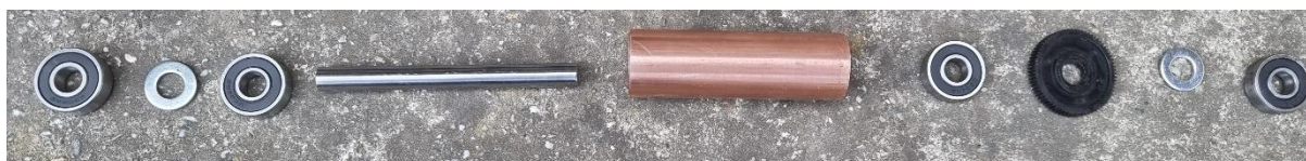
Slika 26. Sastavljanje pogonskog valjka.
