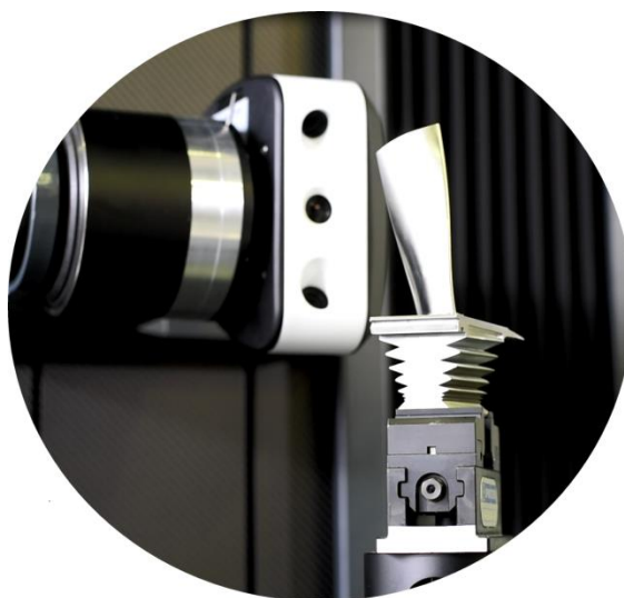
Slika 13 Primjer beskontaktnog senzora sa bijelim svjetlom
