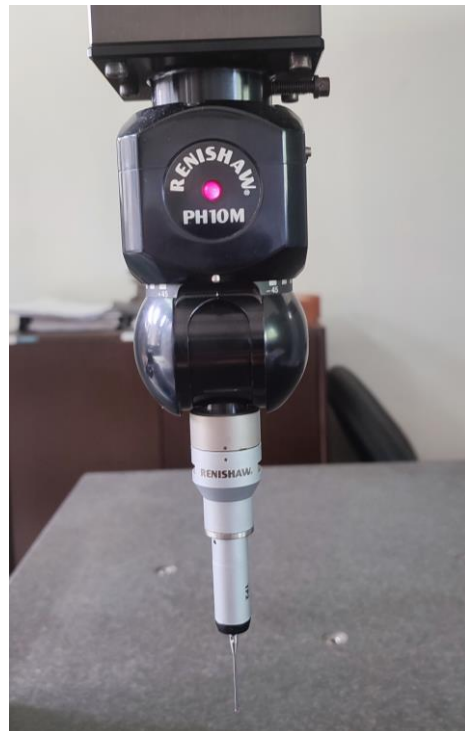
Slika 21 Dimenzije mjerne sonde PH10M
