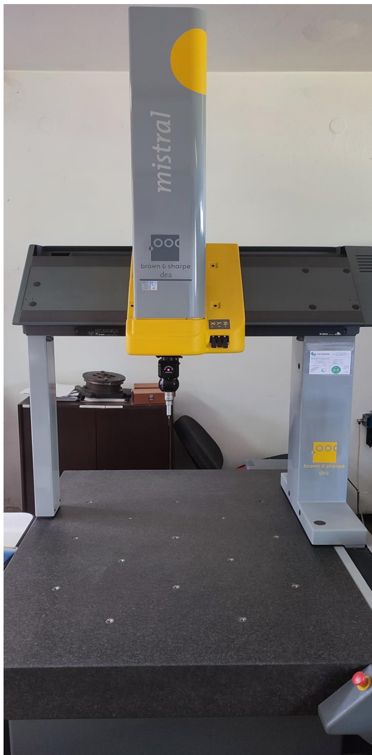
Slika 19 Predodžba mjernog uređaj Dea Mistral. Izvorno autor.
