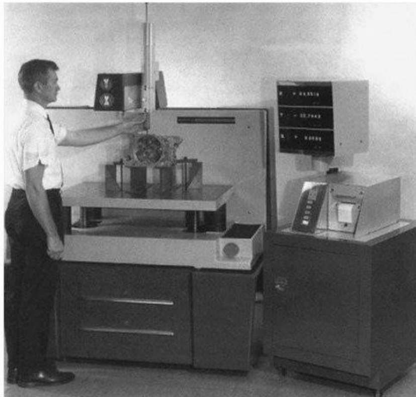
Slika 2 Prikaz ručnog pomicanja probe
