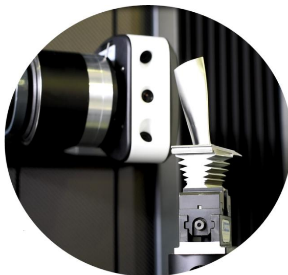
Slika 13 Primjer beskontaktnog senzora sa bijelim svjetlom
