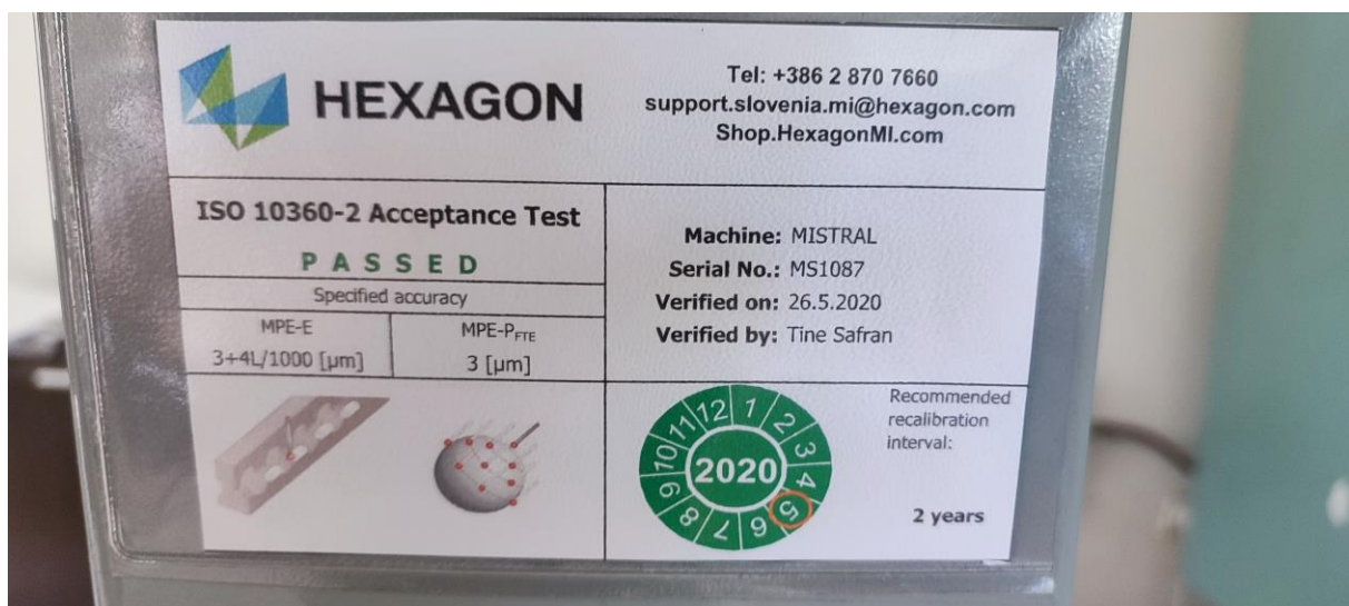
Slika 20 Predodžba potvrde kalibracije mjernog uređaja Dea Mistral. Izvorno autor.
