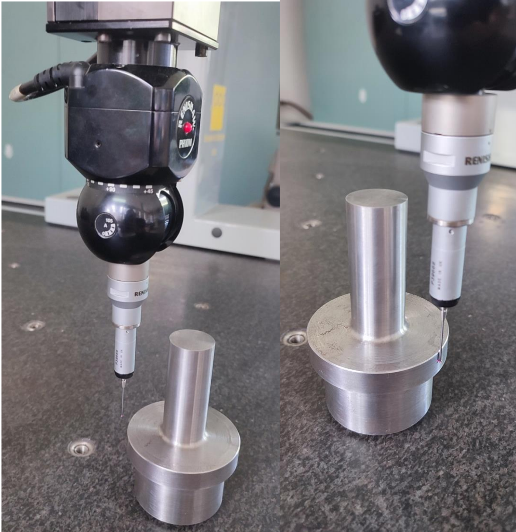
Slika 27 Predodžba prikaza mjerenja promjera. Izvorno autor.
