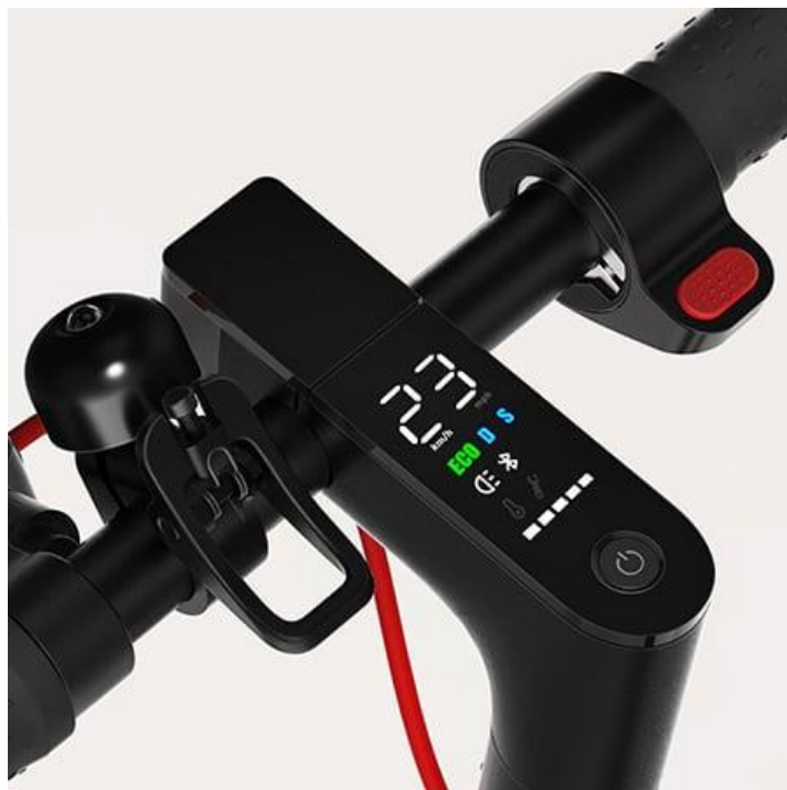
Slika 9 - Upravljačka ploča romobila Xiaomi M365 Pro
