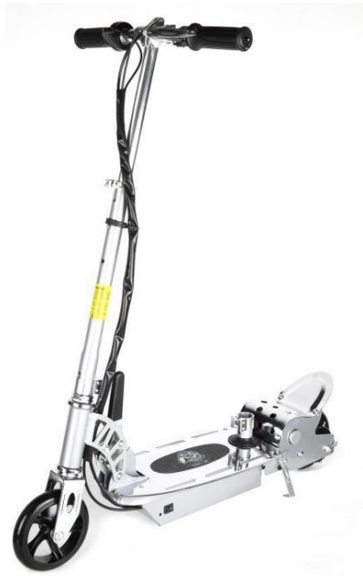
Slika 3 - Dječji električni romobil sa istosmjernim motorom.
