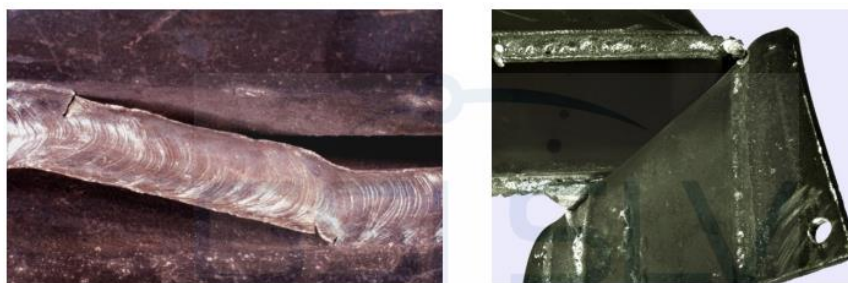
Slika 23. Talina koja je prebrzo padala je uzrokovala nedovoljnu penetraciju pri vertikali prema dolje [4].
