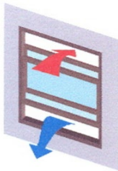
Slika 2. Efikasan otvor za prirodnu ventilaciju [1]
