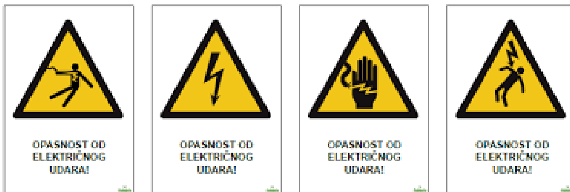
Slika 12. Primjeri oznaka za opasnost od električnog udara [10]
