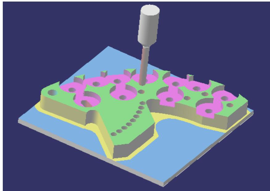
Slika 62. Obradak nakon operacije obrade urezivanja navoja
