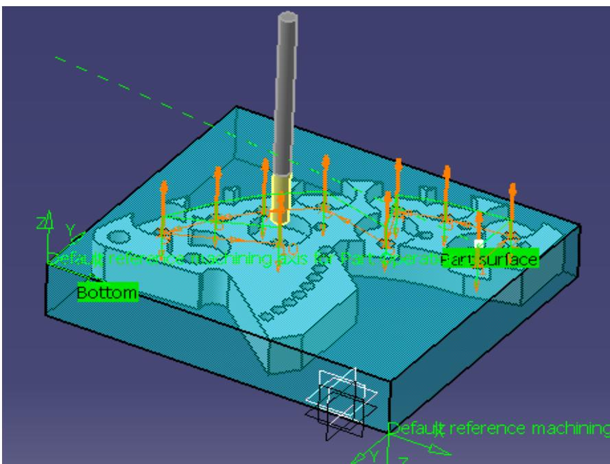
Slika 55. Simulacija putanje alata kod obrade bušenjem
