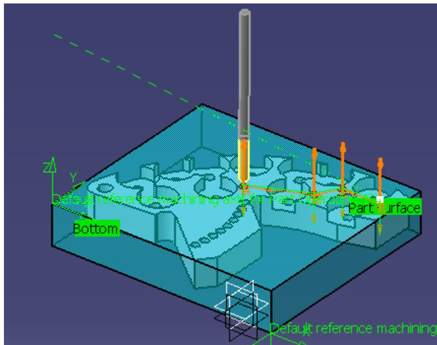
Slika 54. Simulacija putanje alata kod obrade bušenjem
