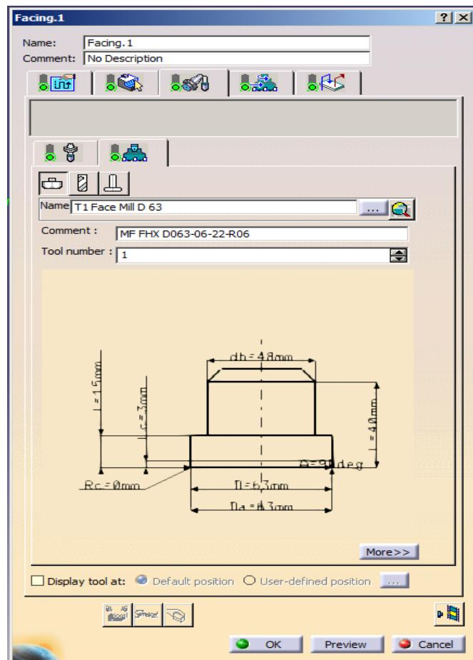
Slika 16. Postavljanje parametara alata i obrade
