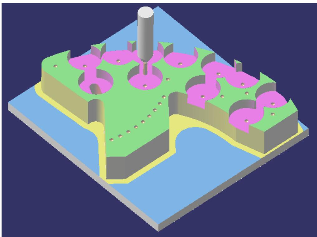
Slika 46. Obradak nakon operacije zabušivanja
