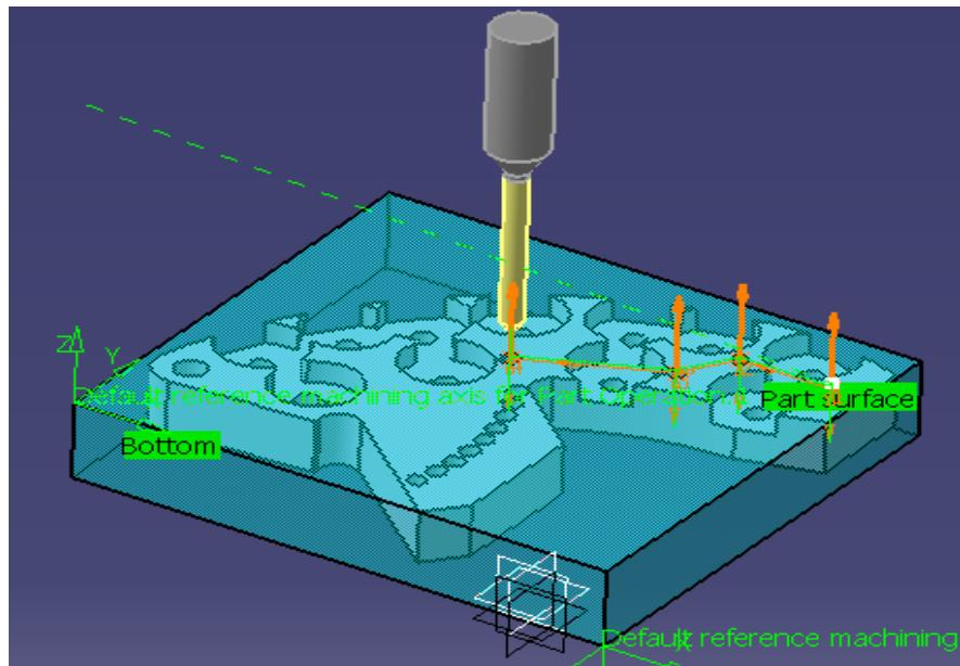
Slika 61. Simulacija putanje alata kod obrade urezivanjem navoja
