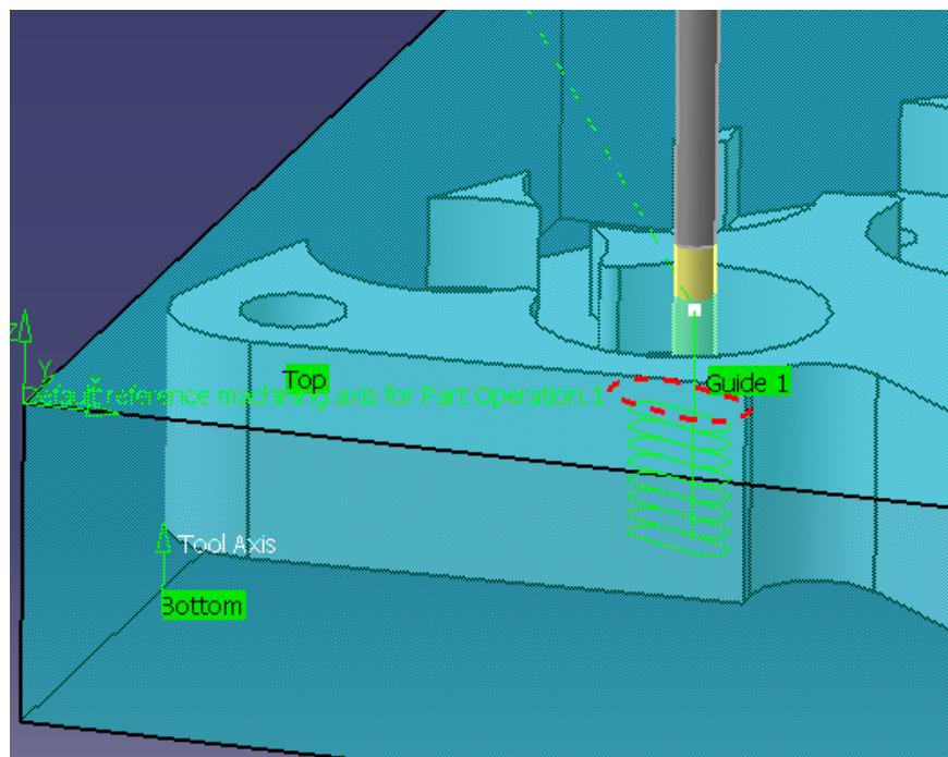
Slika 37. Simulacija putanje petog alata kod obrade četvrтog džepa
