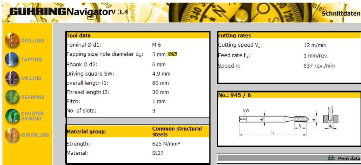
Slika 59. Alat 10. –parametri obrade [10]
