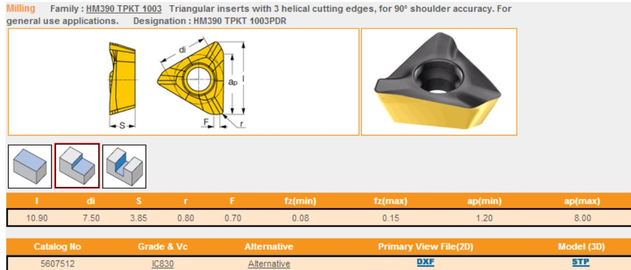
Slika 21. Pločica za alat 2. [8]
