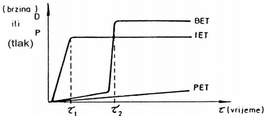
Sl. 5. Stupanj stabilnosti izgaranja eksplozivnih tvari [7]
