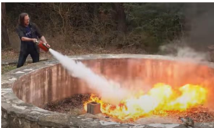
Slika 6. Gašenje požara ugljičnim dioksidom [4]
