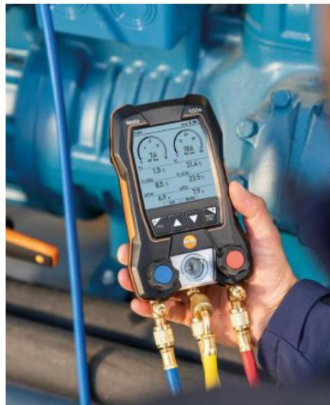
Slika 22. Digitalni manometar [12]
