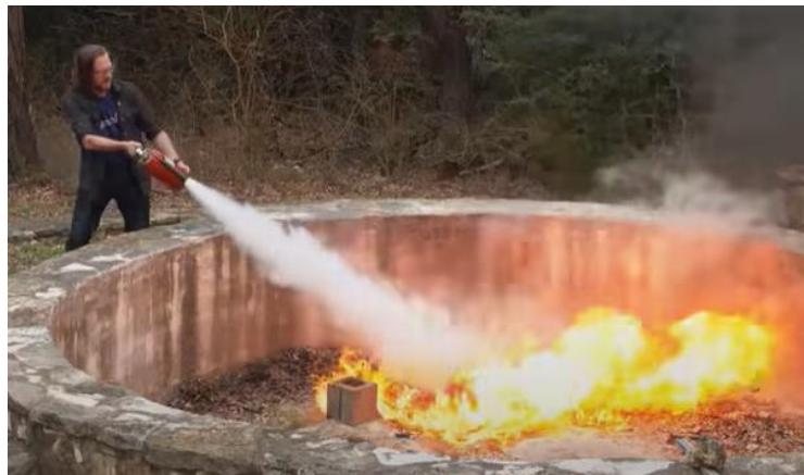
Slika 6. Gašenje požara ugljičnim dioksidom [4]
