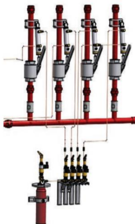
Slika 17. Ventilna stanica u sustavu za gašenje požara ugljičnim dioksidom [7]
