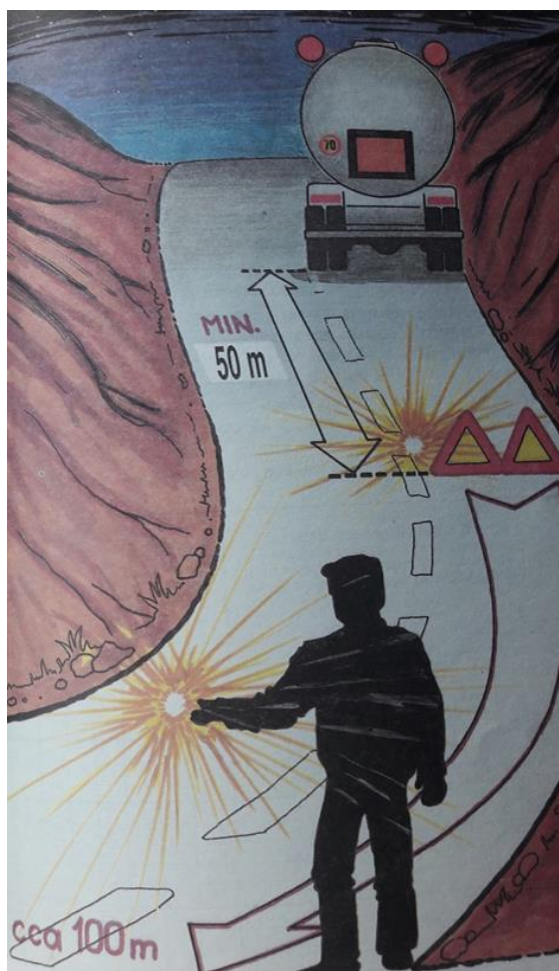
Sl. 14. Obilježavanje vozila zaustavljenog zbog kvara - noću [1]
