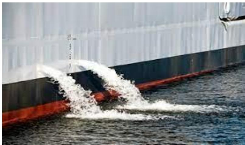
Slika 7. Ispuštanje balastnih voda [29]
