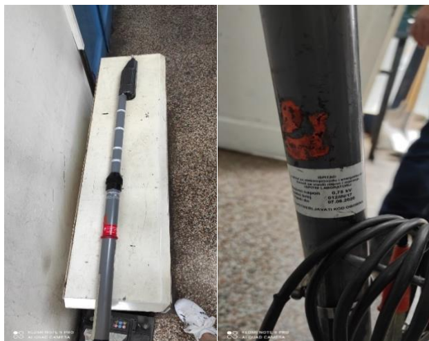
Slika 23. i 24. Detektor napona 6 – 690 V [9]
