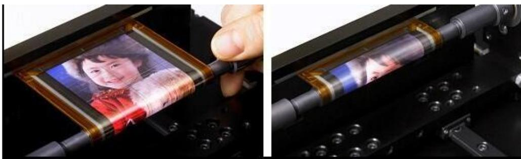
Slika 8. Demonstracija prototipa fleksibilnog OLED zaslona tvrtke Sony [13]
