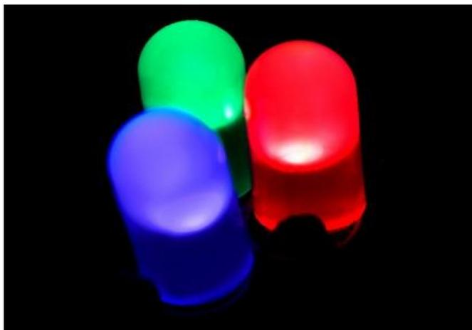
Slika 3. Svjetleće diode [6]
