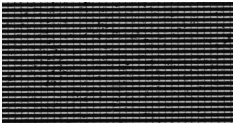
Slika 9. Stari OLED zaslon koji pokazuje potrošenost [13]
