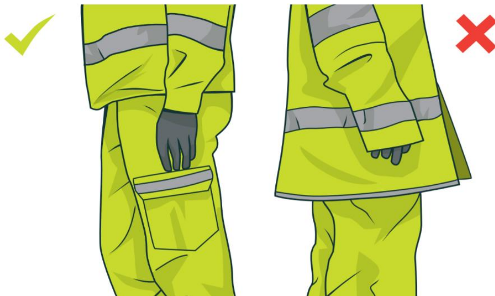
Slika 2. Prikaz ispravnog i neispravnog nošenja zaštitne odjeće [4]
