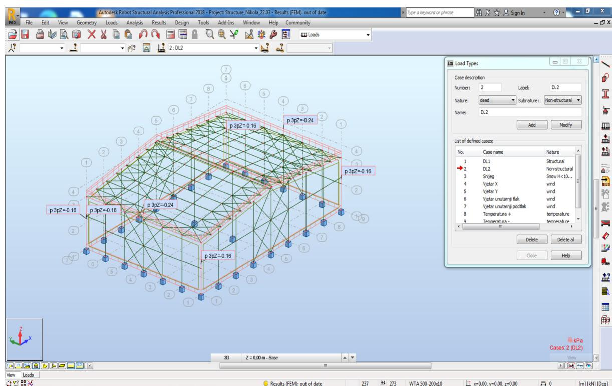
Slika 9. Prikaz djelovanja opterećenih panela i instalacija
