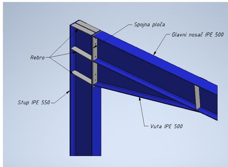
Slika 21. Prikaz spoja stupa i glavnog nosača
