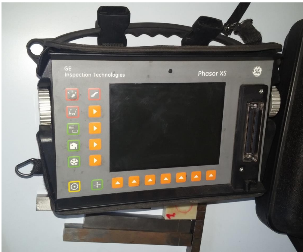
Slika 29. Uređaj za ispitivanje GE Inspection Technologies Phasor XS
