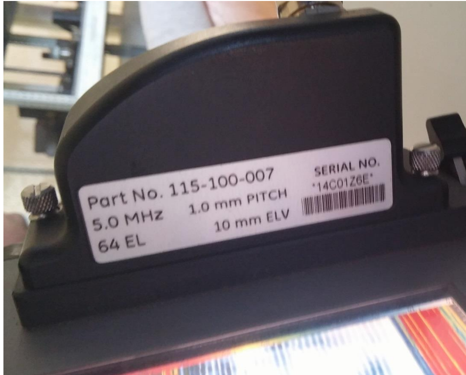
Slika 32. Sonda 5 MHz, 64 elementa
