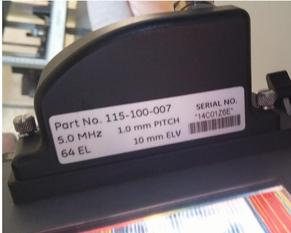
Slika 32. Sonda 5 MHz, 64 elementa
