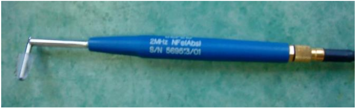
Slika 8. Apsolutna sonda za ispitivanje vrtložnim strujama
