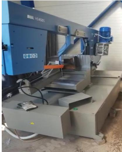
Slika 31. Horizontalna tračna pila
