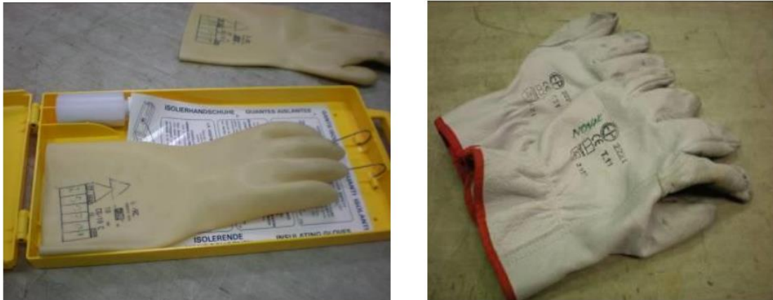
Slika 17. Komplet izolacijskih rukavica i kožnih nadrukavica za RPN na NN[15]
