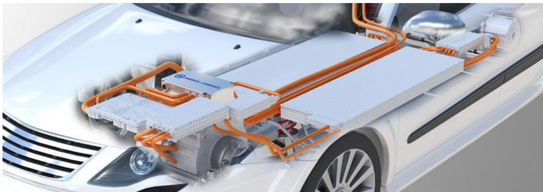
Slika 11. Ožičenje visokog napona u vozilu [9]
