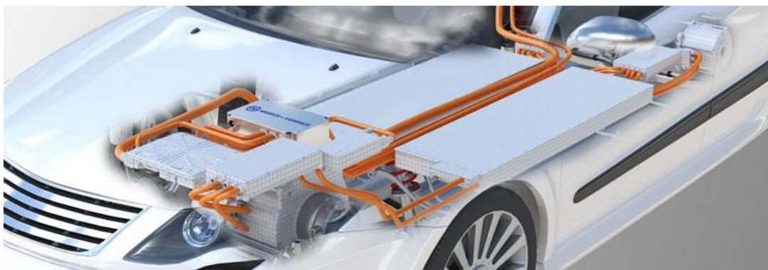
Slika 11. Ožičenje visokog napona u vozilu [9]
