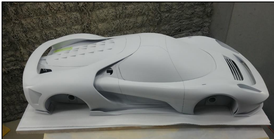
Slika 26. Konceptualni model automobila izrađen aditivnom tehnologijom [28]
