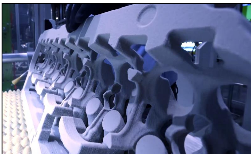
Slika 27. Pješčani kalup bloka motora bolida Formule 1 [29]
