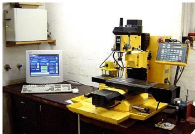
Slika 2. Prikaz CNC glodalice [12]
