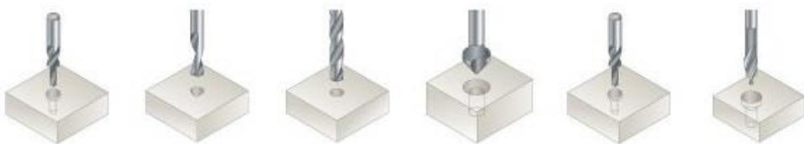
Slika 7. Obrada bušenja, zabušivanja, proširivanja ( razvrtavanja ) i upuštanja rupa [16]
