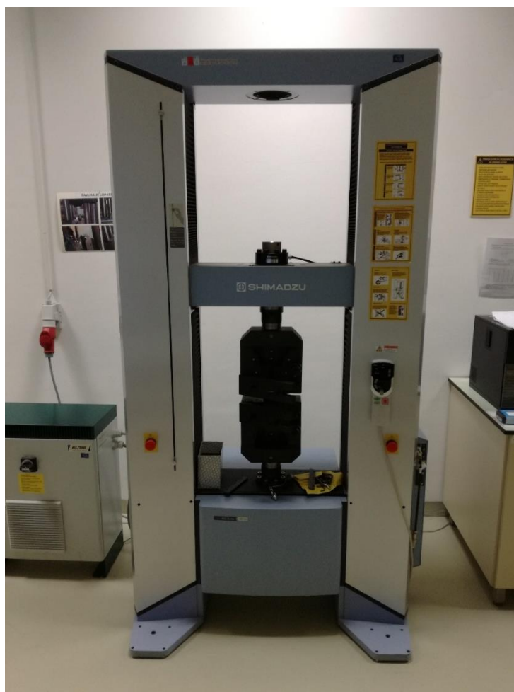
Slika 12. Kidalica Shimadzu AG-X Plus
