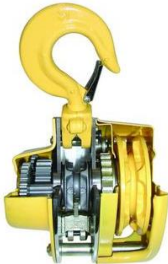
Slika 4. Prikaz unutarnjih dijelova ručne lančane dizalice[7]
