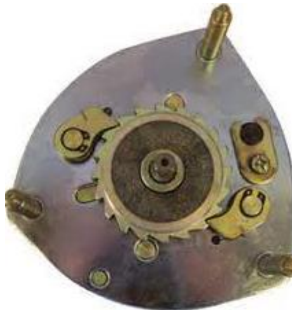
Slika 13. Prikaz kočnog mehanizma[13]
