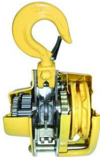
Slika 4. Prikaz unutarnjih dijelova ručne lančane dizalice[7]
