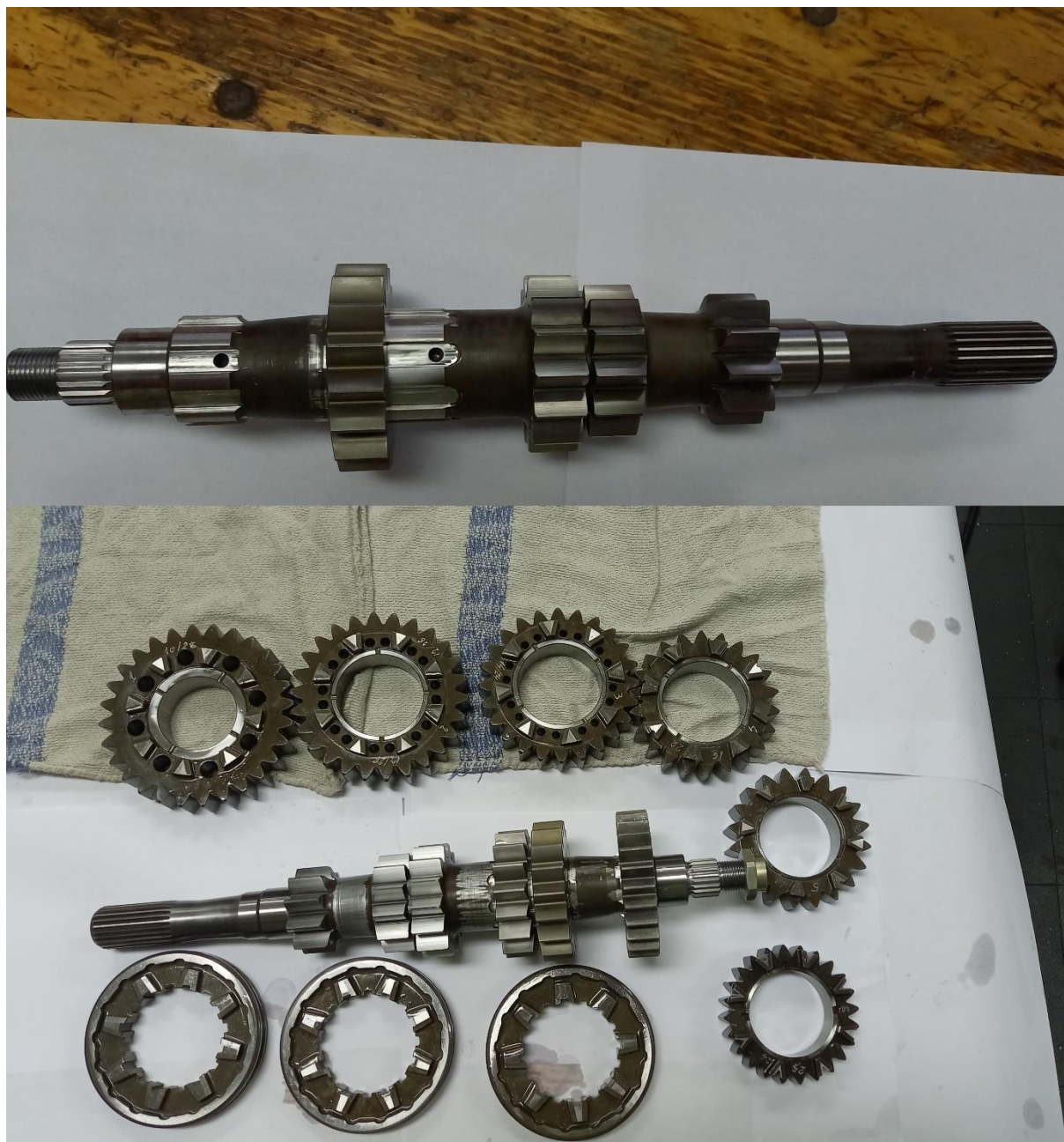
Slika 60. Montirani zupčanici na pogonskom vratilu.
