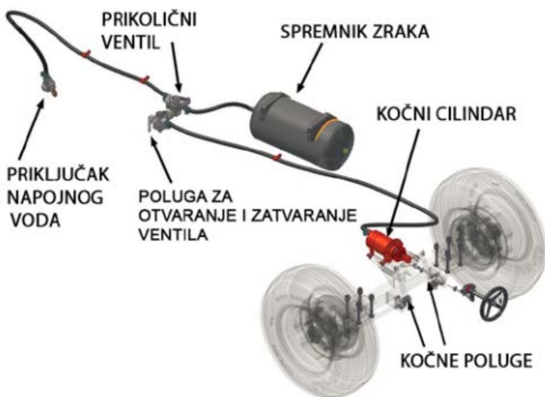
Slika 8. Primjer tipične jednovodne zračne kočne instalacije na traktorskoj prikolici
