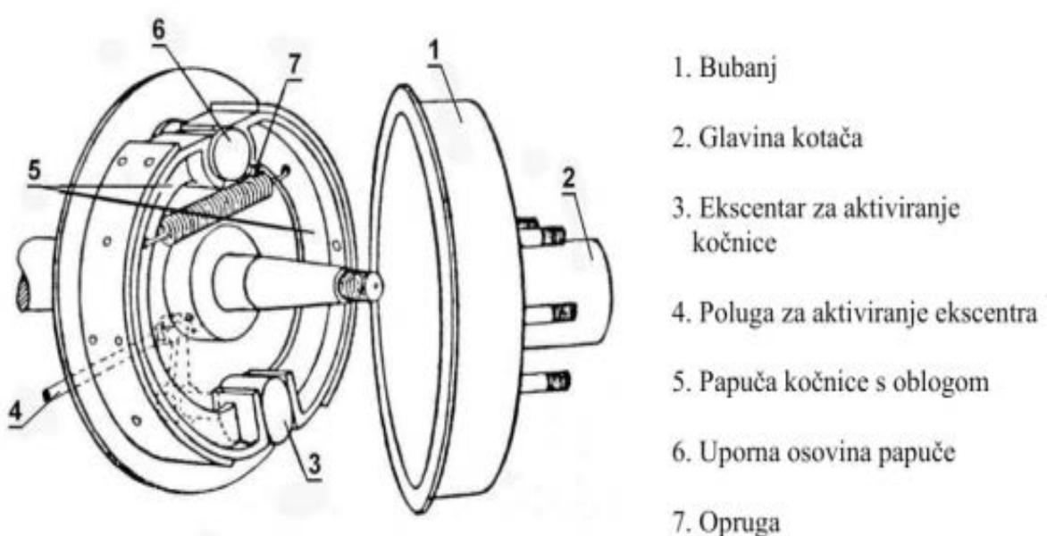
Slika 4. Konstrukcija i princip rada kočnice s bubnjem [8]
