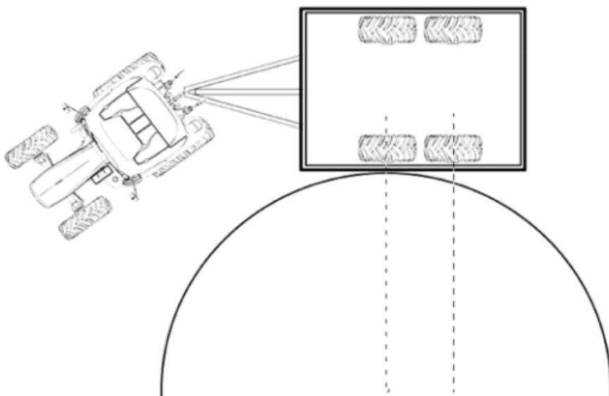
Slika 11. Zakretanje cijelog priključnog vozila s krutom osovinama [8]
