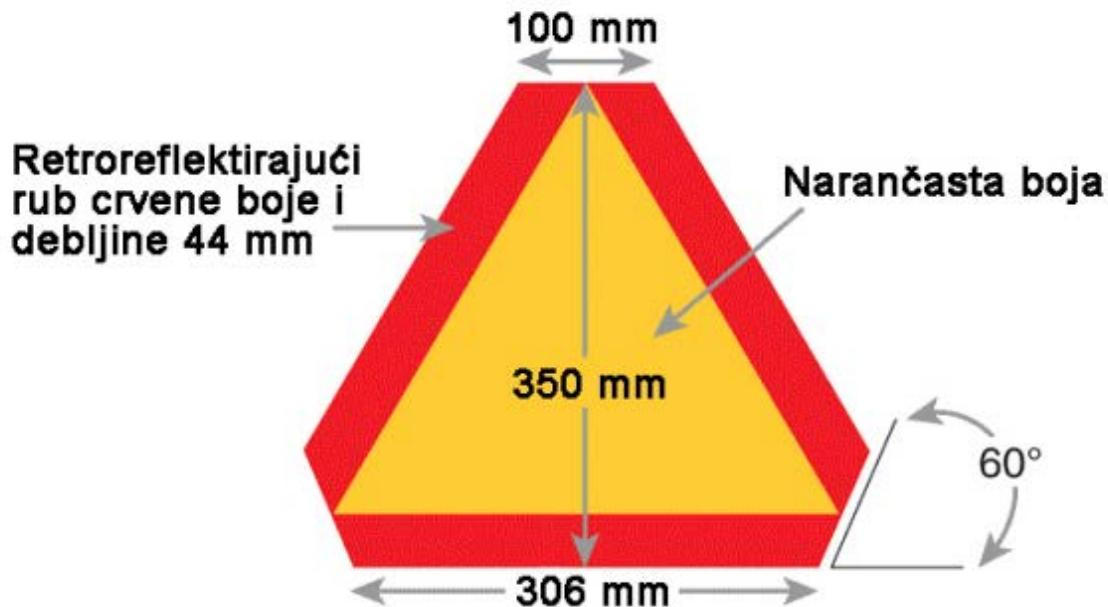
Slika 20. Ploča za označavanje „sporih vozila“ [8]
