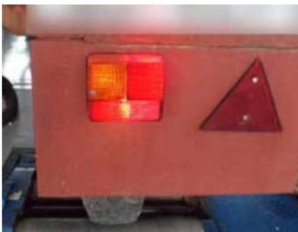
Slika 22. Kočna svjetla na prikolici [8]
