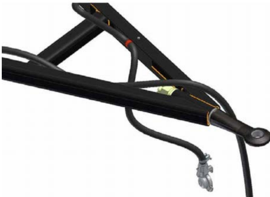
Slika 24. Rudo za zakretanje osovine kod prikolice [8]
