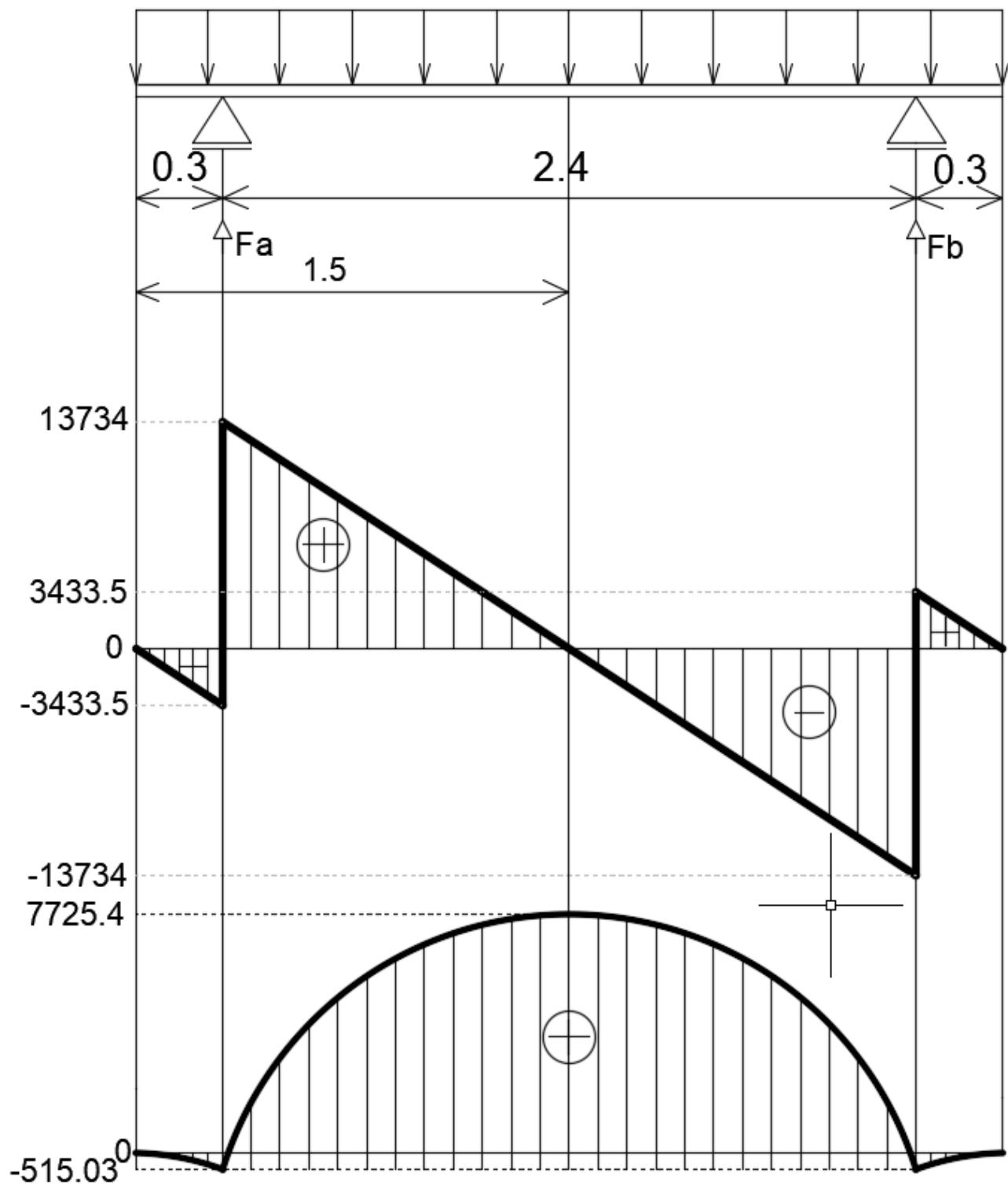
Slika 17. Dijagram poprečnih sila  $Q(x)$  i momenta savijanja  $M(x)$
