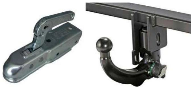
Slika 3. Priključna spojka i auto kuka [4]
