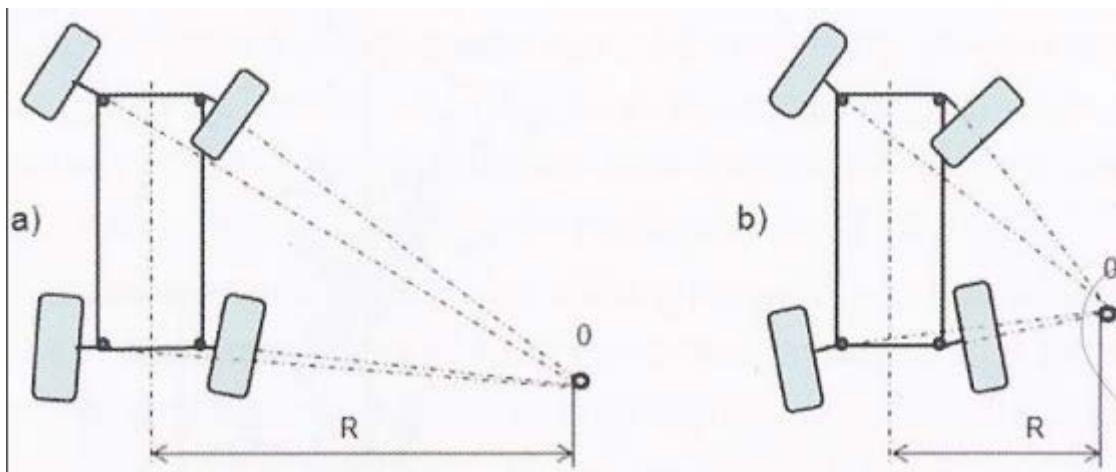
Slika 13. Shematski prikaz pozitivnog smjera stražnjih kotača. [9]
