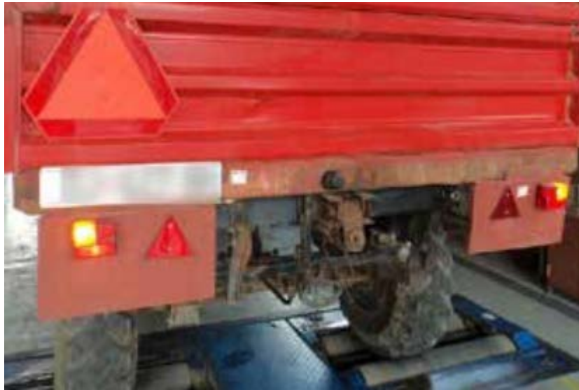
Slika 23. Pokazivači smjera na prikolici [8]
