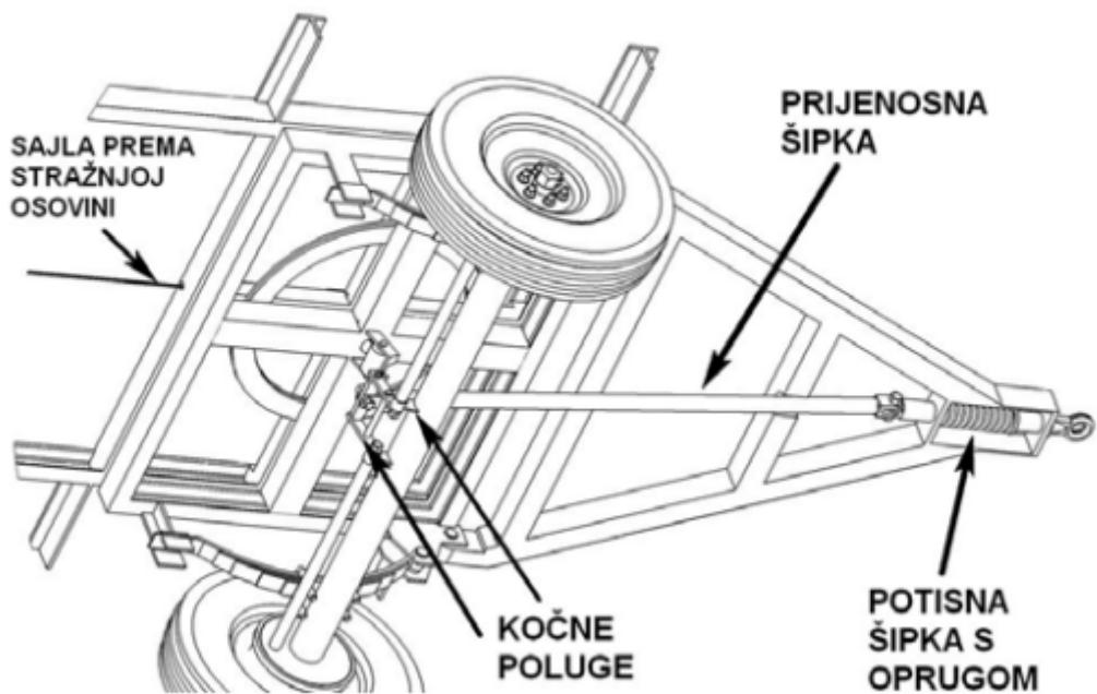
Slika 6. Primjer konstrukcije naletne kočnice na traktorskoj prikolici [8]
