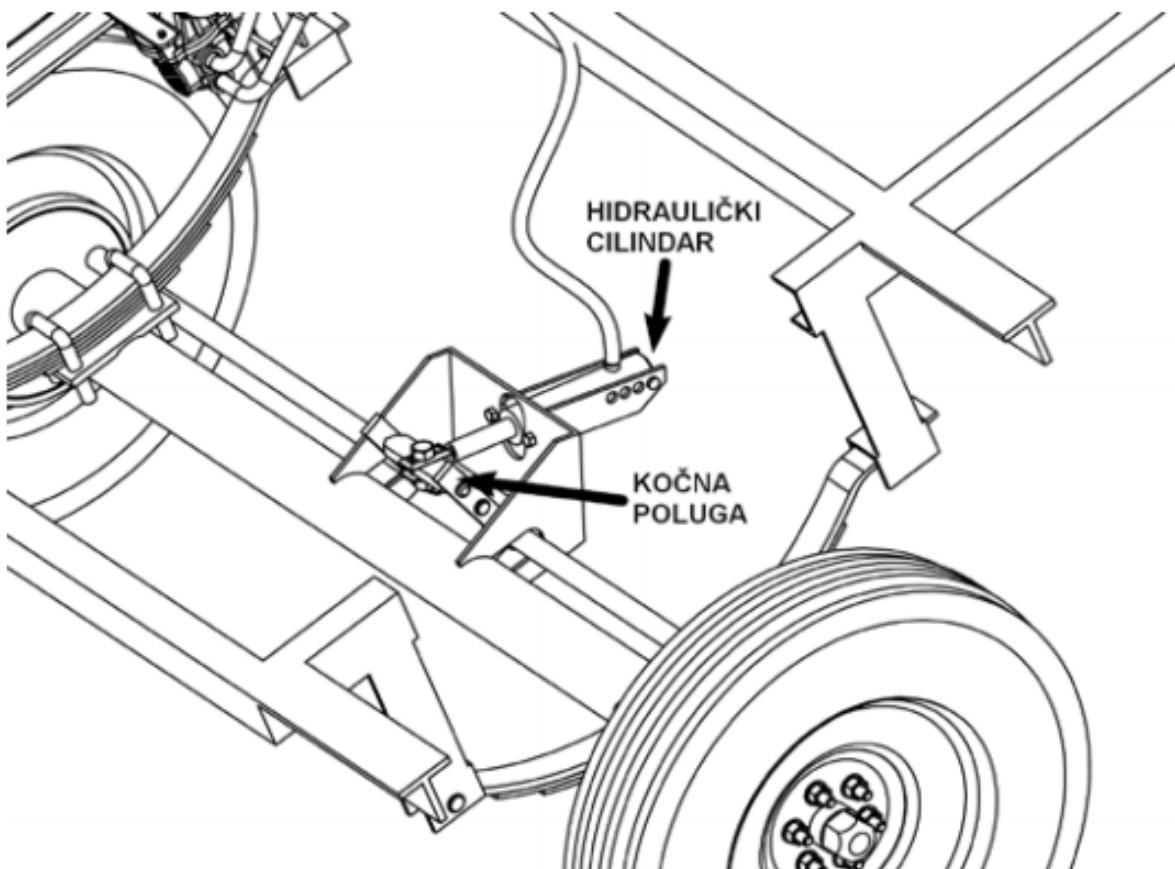
Slika 7. Primjer konstrukcije hidrauličke kočnice na traktorskoj prikolici [8]
