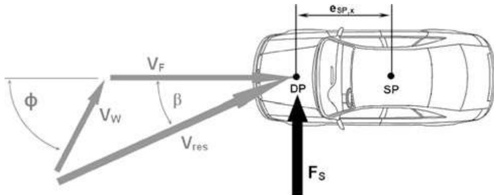
Slika 10. Sile i kut bočnog klizanja vozila [8]
