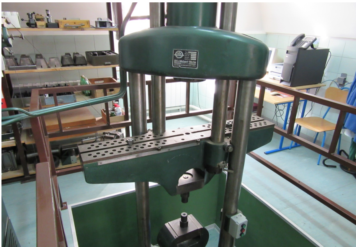
Slika 6.1. Radno mjesto kidalica Otto Wopert Werke U60
