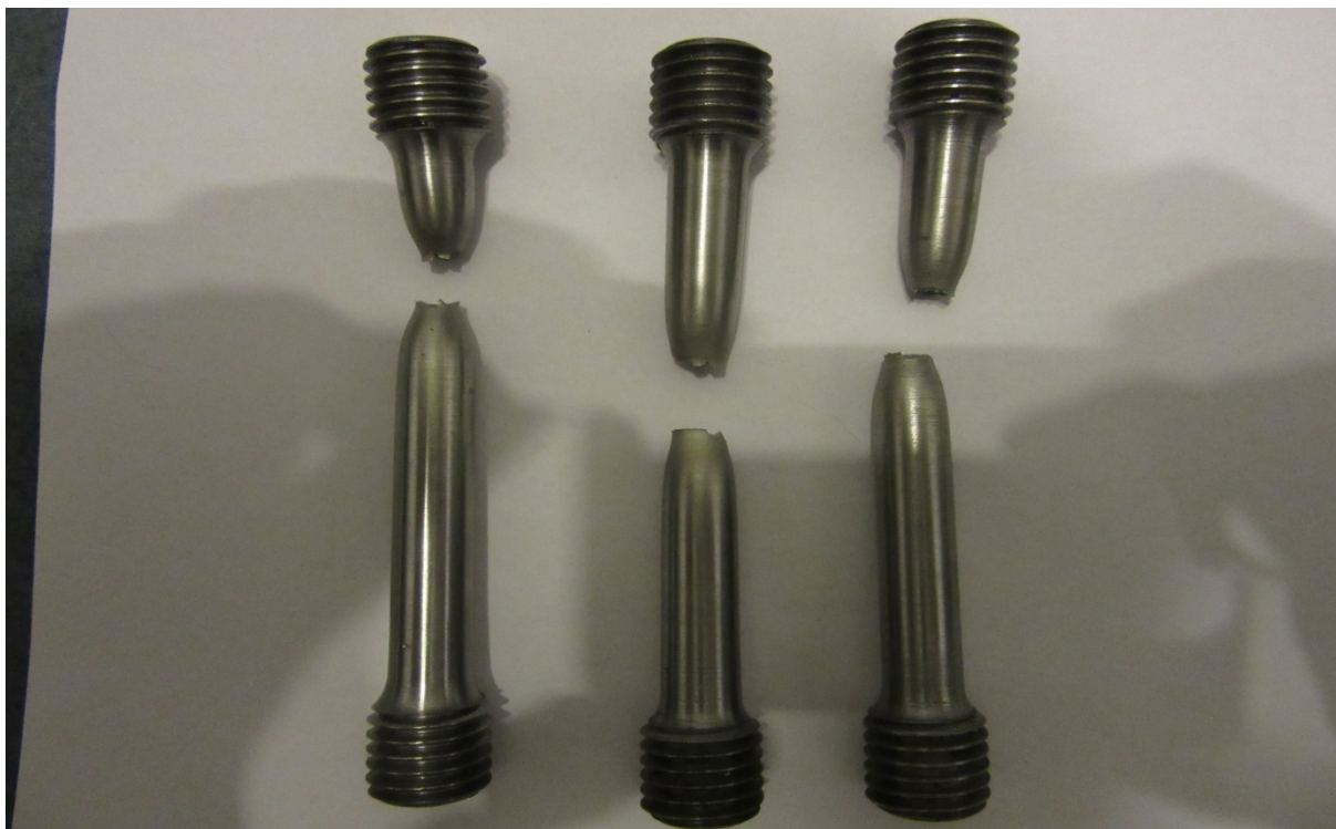
Slika 6.1.1. Pokidane epruvete prije toplinske obrade
