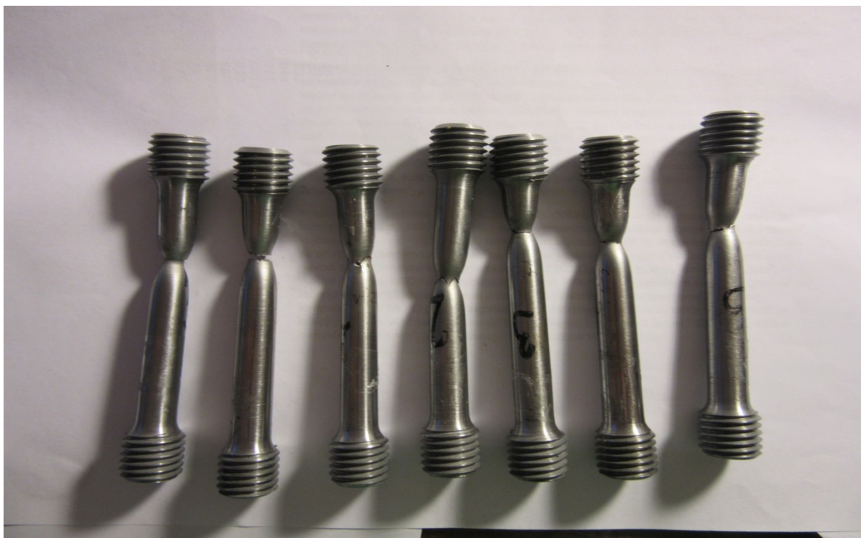
Slika 7.4. Pokidane epruvete poslije toplinske obrade.
