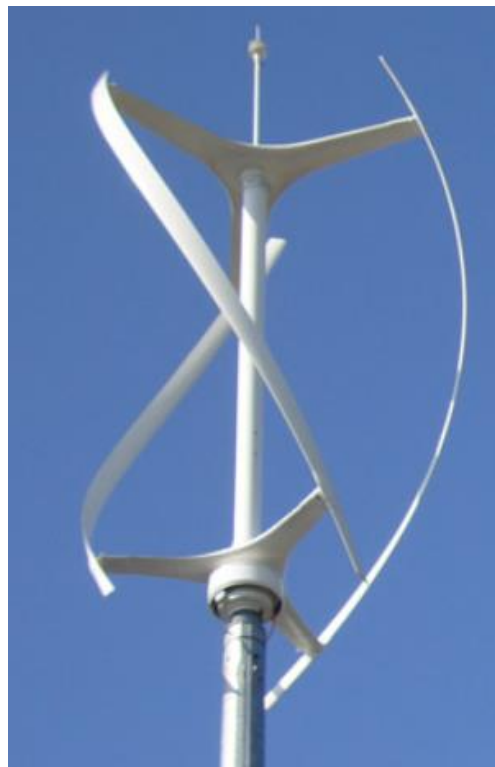
Slika 27 - Darrieusova vjetroturbina s spiralnim lopaticama [12]
