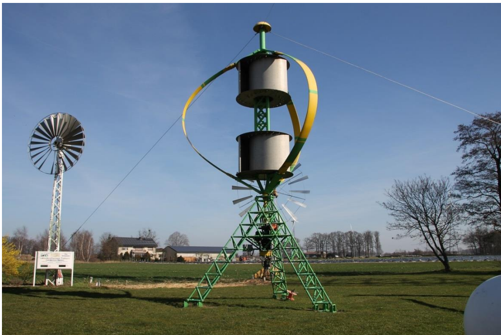
Slika 30 - Hibridna Savonius-Darrieus vjetroturbina [12]
