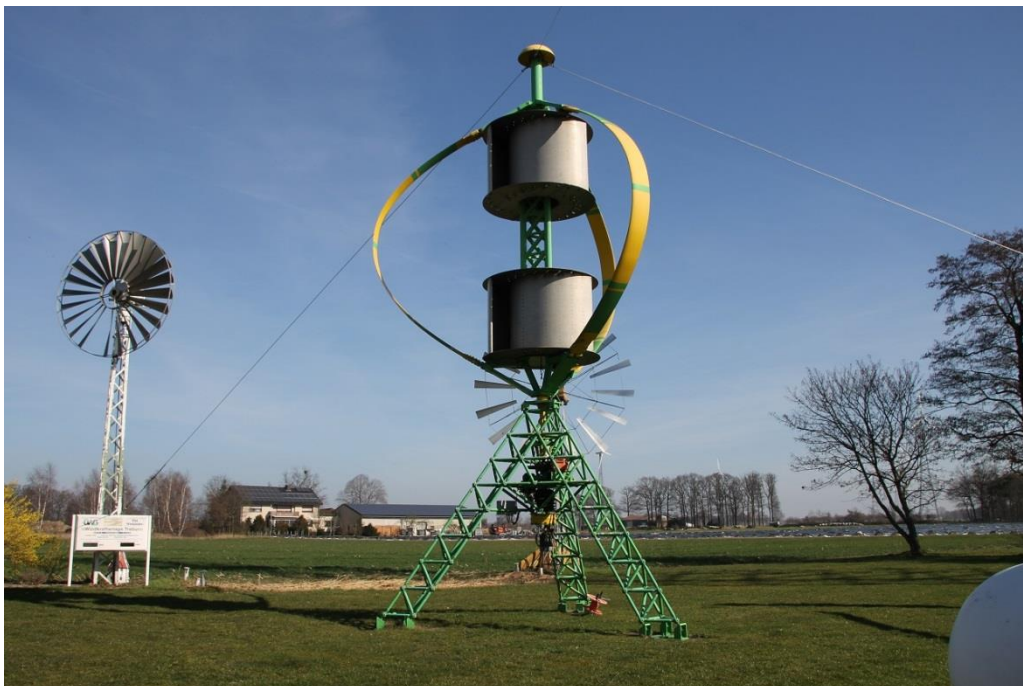
Slika 30 - Hibridna Savonius-Darrieus vjetroturbina [12]
