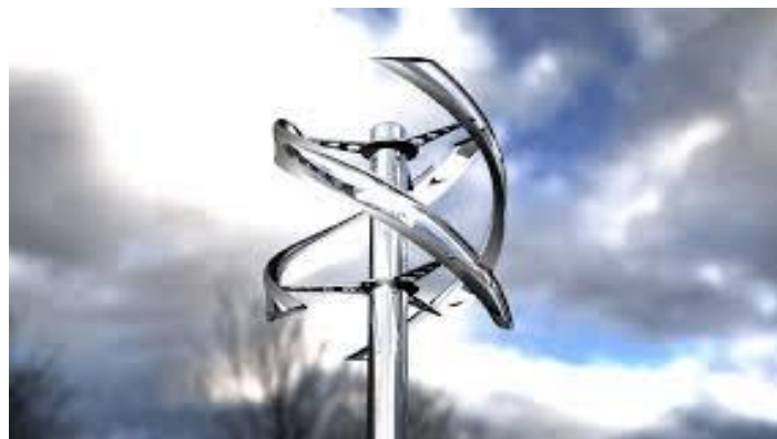
Slika 15 - Tip vjetroturbine sa spiralnim lopaticama [7]
