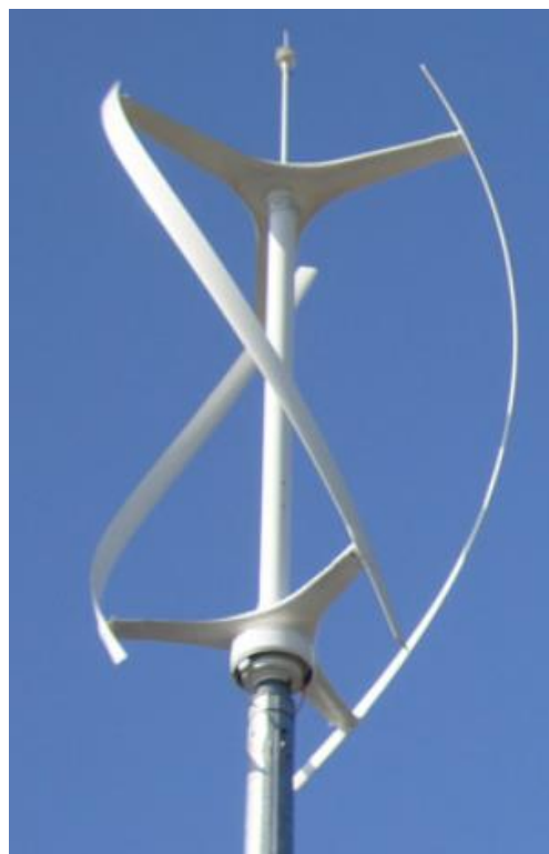
Slika 27 - Darrieusova vjetroturbina s spiralnim lopaticama [12]
