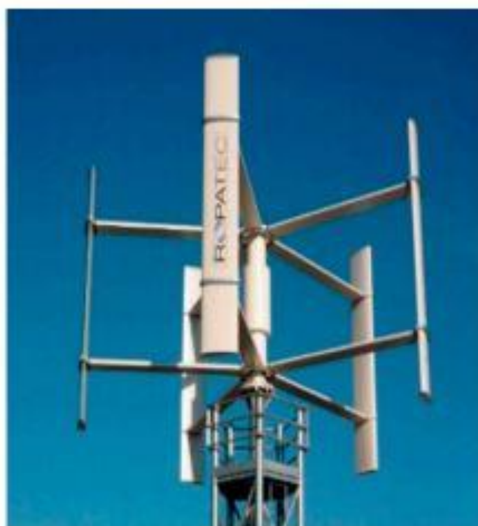
Slika 26 - Darrieusova vjetroturbina s više lopatica [8]
