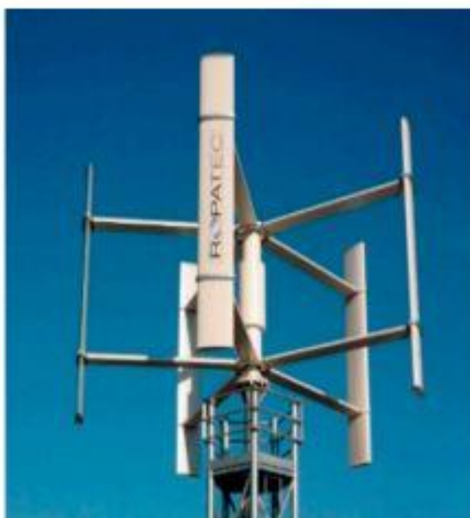
Slika 26 - Darrieusova vjetroturbina s vise lopatica [8]
