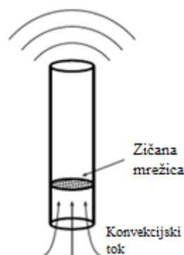
Slika 3. Shema Rijkeove cijevi [4]
