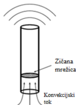
Slika 3. Shema Rijkeove cijevi [4]
