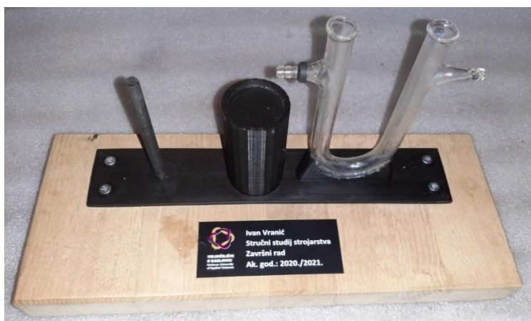
Slika 28. Zalijepljena U-cijev s dodanom brtvenom gumicom
