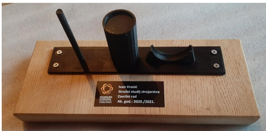
Slika 27. Postolje i nosač spojeni vijcima
