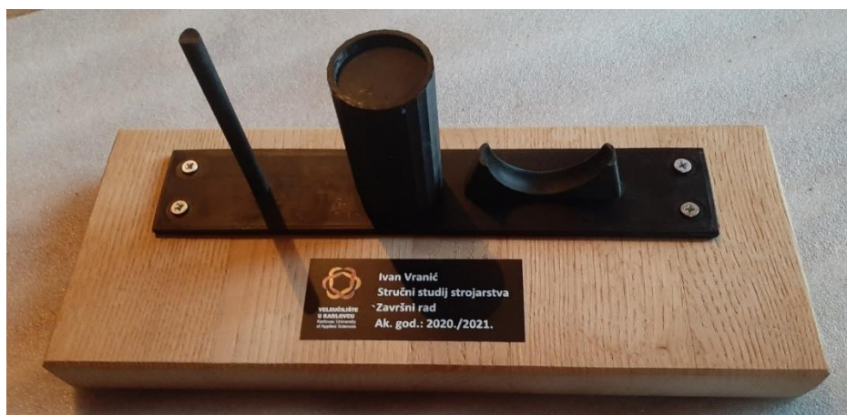
Slika 27. Postolje i nosač spojeni vijcima
