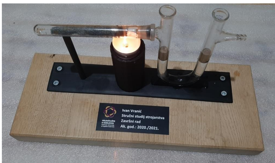
Slika 32. Maketa nakon dodavanja izvora topline
