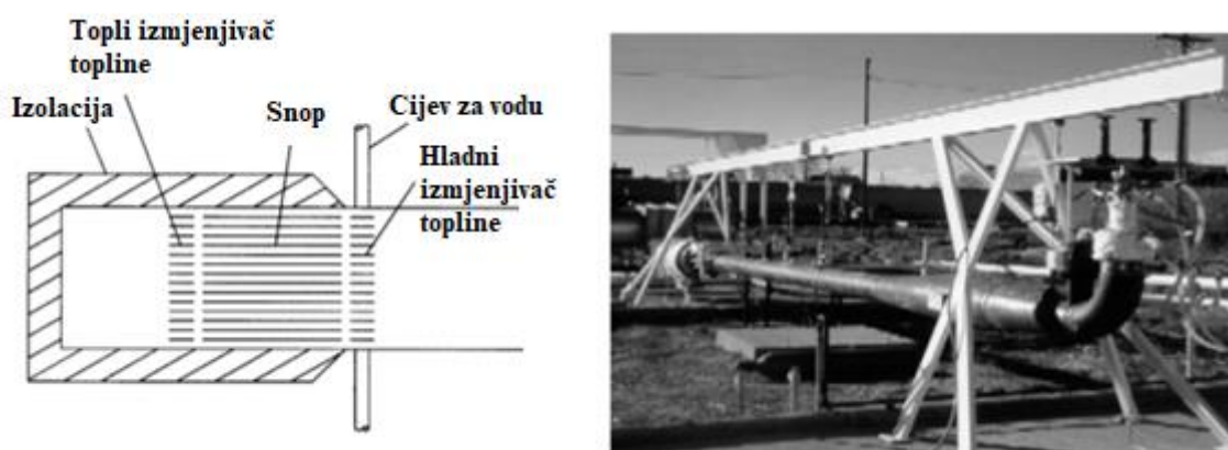
Slika 13. Termoakustični uređaj sa „stojnim“ valom [15]
