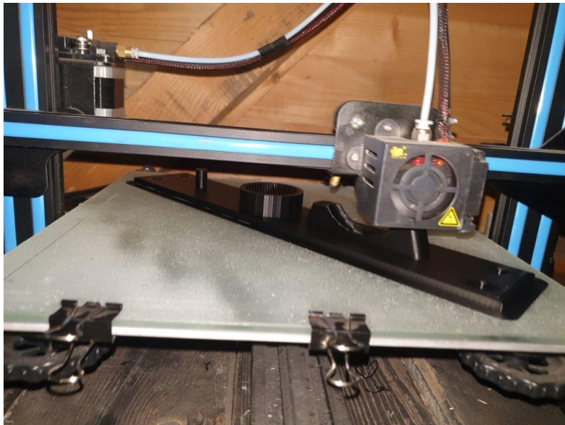
Slika 23. Nosač u procesu printanja
