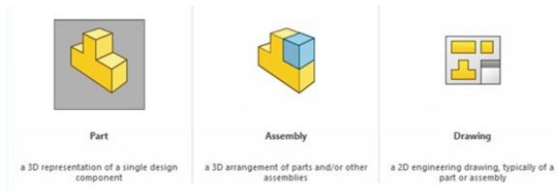
Slika 15. Tri osnovna načina rada u SolidWorksu
