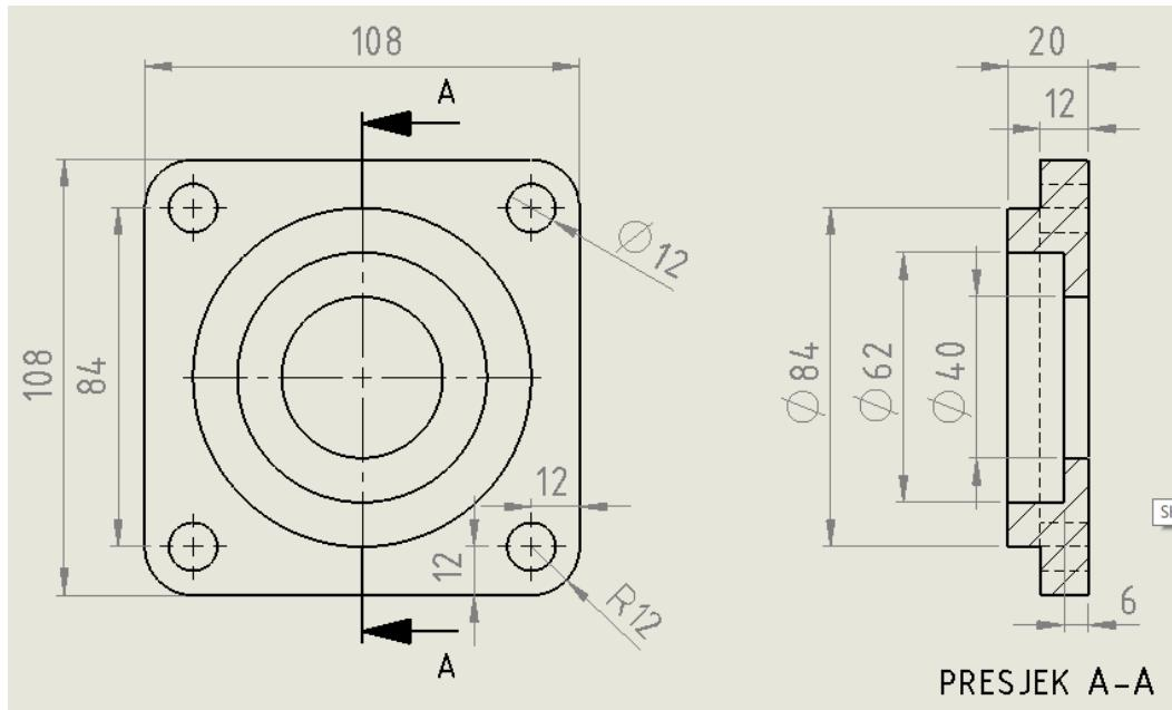
Slika 27. Tehnički podaci prototipa kućišta kugličnog ležaja
