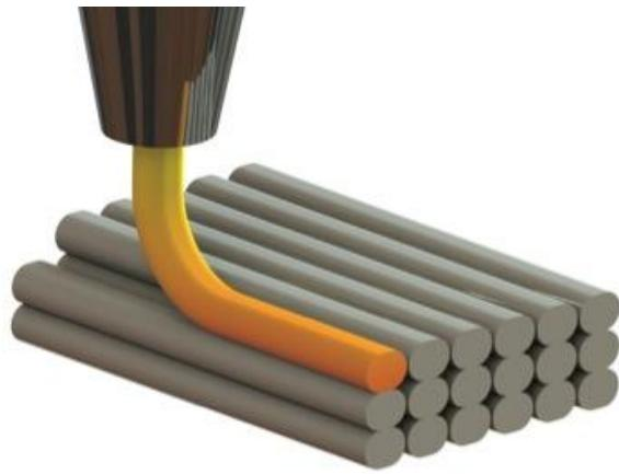
Slika 13. Prikaz nanošenja materijala "sloj po sloj" [31]
