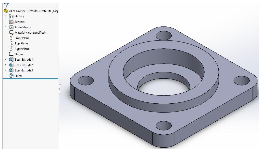
Slika 26. 3D model prototipa kućišta kugličnog ležaja
