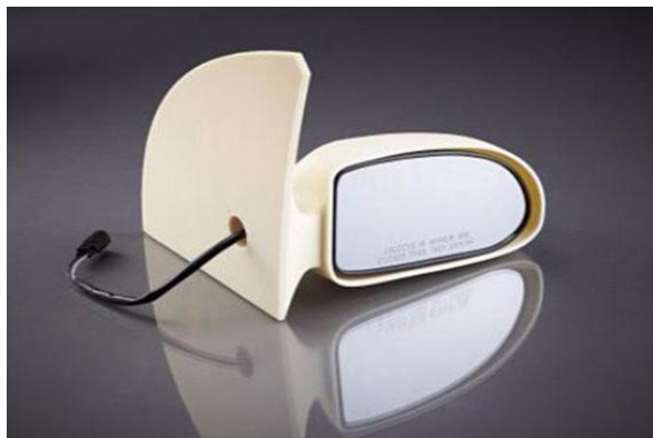
Slika 6. Model izrađen ASA materijalom
