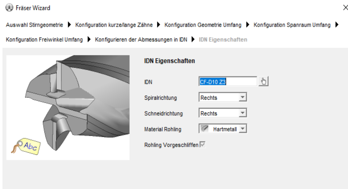
Slika 28. Odabir smjera oštrice i vrste materijala
