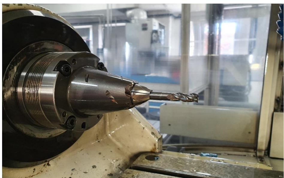
Slika 33. Gotov rezni alat pri završetku obrade
