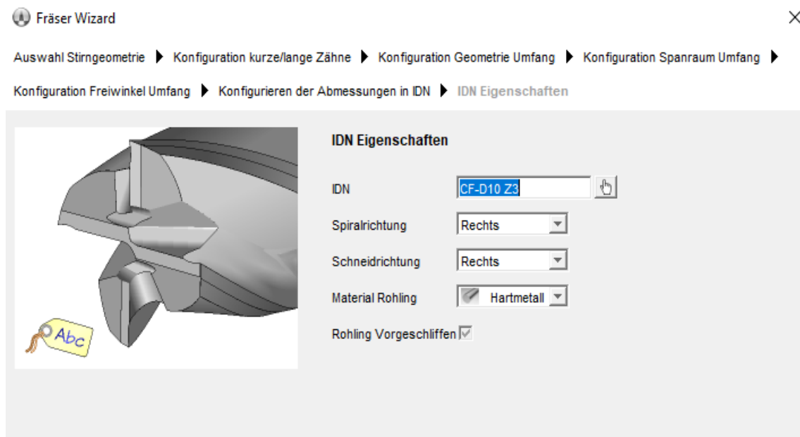
Slika 28. Odabir smjera oštice i vrste materijala
