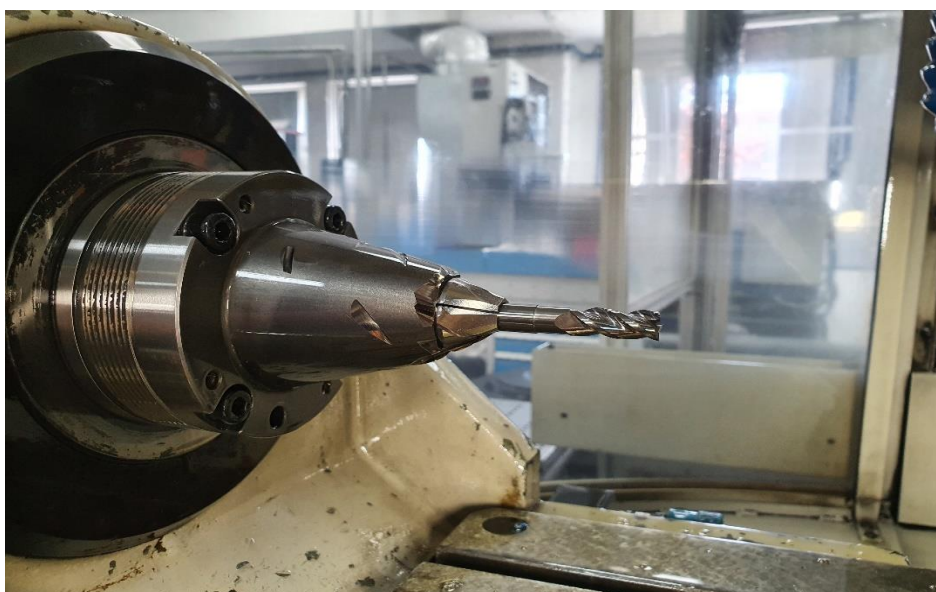
Slika 33. Gotov rezni alat pri završetku obrade
