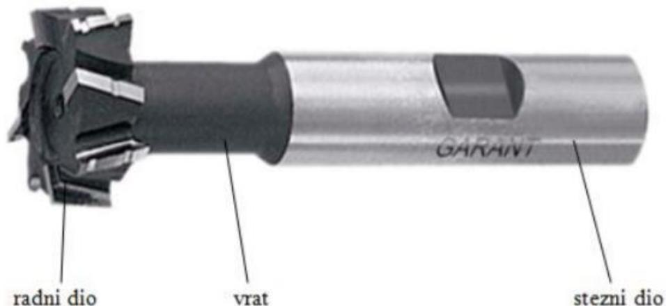
Slika 18. Osnovni elementi glodala
