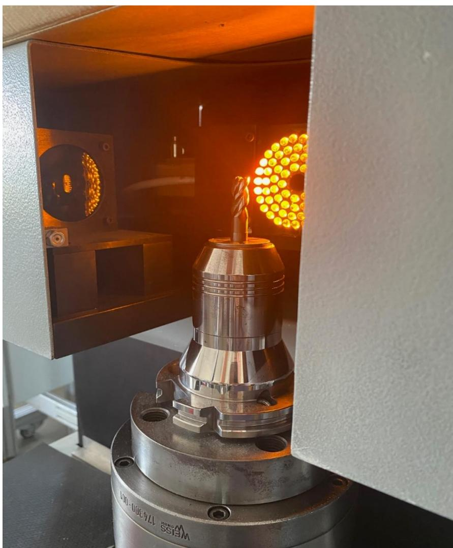
Slika 39. Rezni alat postavljen u uređaj za mjerjenje i izračunavanje geometrijskih parametara
