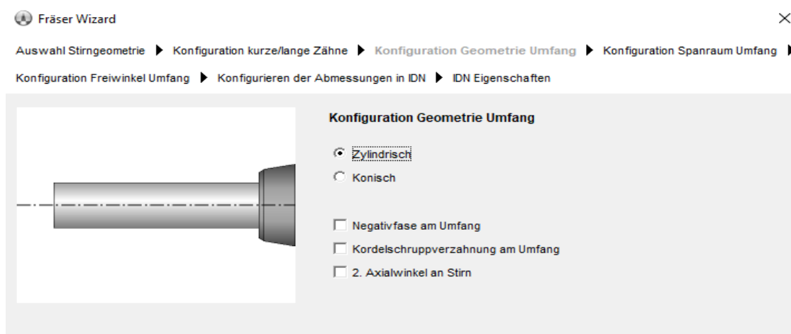
Slika 24. Konfiguracija geometrije promjera
