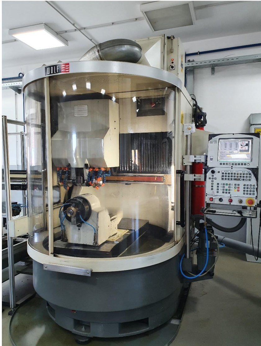
Slika 29. Pet osni CNC obradni centar Walter HMC 400
