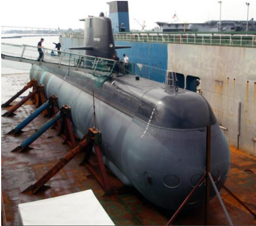
Slika 21. Švedska podmornica Gotland pogonjena Stirlingovim motorom [65]
