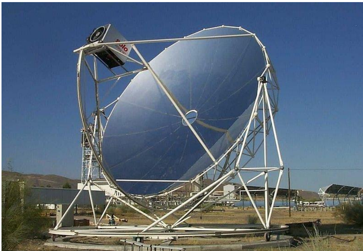
Slika 10. Solarni tanjur sa Stirlingovim motorom za napajanje [54]
