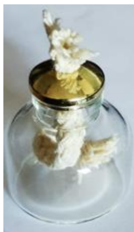
Slika 23. Rezervoar kerozina sa fitiljem [Izvor: Rad autora]
